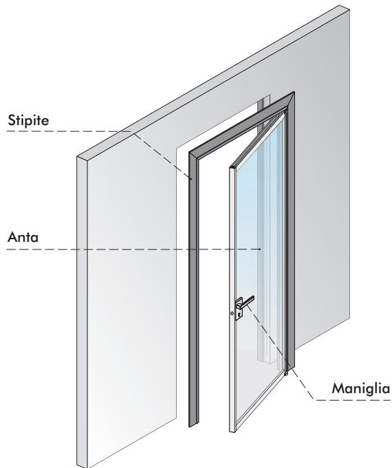
Le porte del sistema **Battente** possono essere adattate ai vari spessori di muro assecondando le diverse necessità di arredo dei locali a cui vengono destinate.
