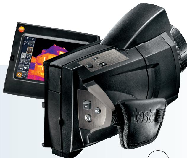
La termocamera testo 885 è lo strumento di misura professionale per localizzare senza contatto le anomalie e i punti deboli che si celano nei materiali e negli elementi costruttivi. Grazie al pregiato sistema di misura all'infrarosso è possibile riconoscere con sicurezza anche le più piccole dispersioni energetiche e i ponti termici più nascosti negli edifici, così come eventuali danni e surriscaldamenti negli impianti industriali.
