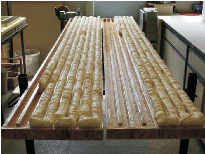
sinistra: SITOL SCHIUMAPUR MULTIUSO destra: Schiuma poliuretanica convenzionale
