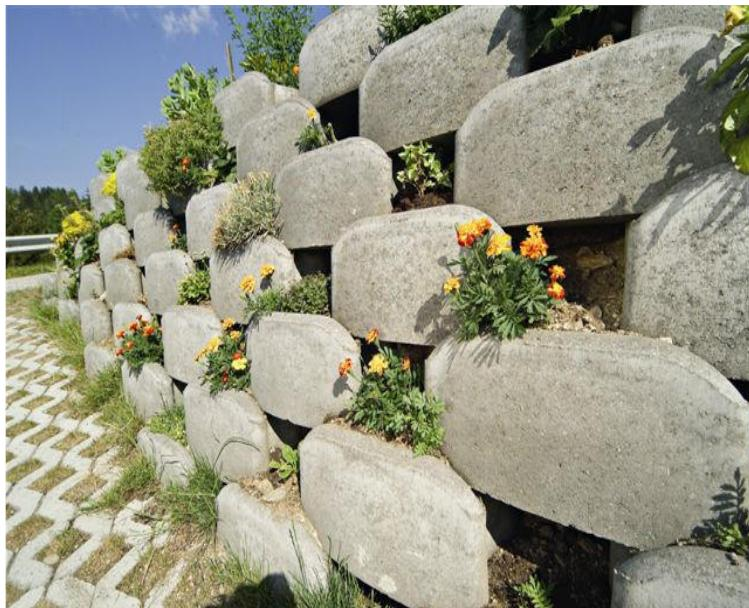
E' possibile utilizzare gli elementi FBK Green Mini per muri con inclinazioni 25°÷70°. Il blocco, non essendo dotato di incastro fisso, consente di variare l'inclinazione verticale a piacimento ed adattare il muro alla scarpata esistente. E' possibile creare curve concave e convesse nei limiti descritti a seguire.
