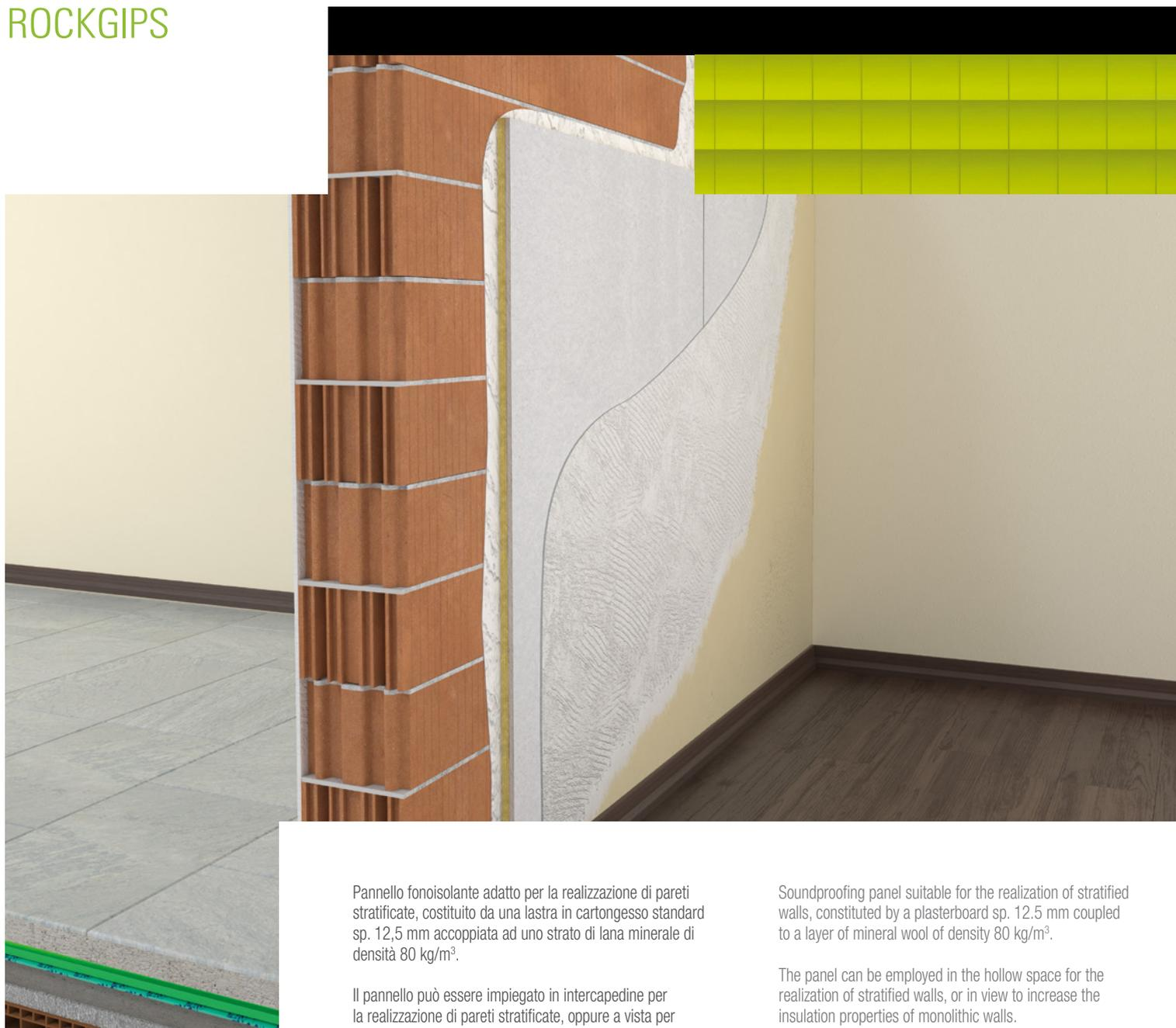
Pannello fonoisolante adatto per la realizzazione di pareti stratificate, costituito da una lastra in cartongesso standard sp. 12,5 mm accoppiata ad uno strato di lana minerale di densità 80 kg/m<sup>3</sup>.
