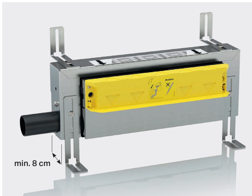
↑ Spessore minimo 8 cm, Geberit Combifix sifone per docce.
