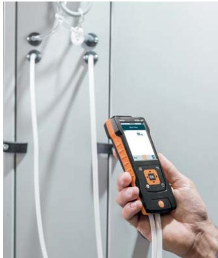
Il modello testo 440 dP con sensore della pressione differenziale vi permette di controllare se i filtri dell'impianto di condizionamento funzionano correttamente, evitando che le particelle dannose contenute nell'aria esterna entrino nel locale.
