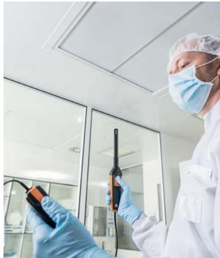
Dovete misurare anche in ambienti dove non è possibile/ammesso l'uso di Bluetooth? Nessun problema: basta scollegare il puntale dell'impugnatura Bluetooth e collegarlo all'impugnatura con cavo.
