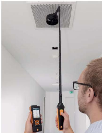
La sonda ad elica 100 mm può essere comodamente collegata alla sonda ad angolo di 90° con prolunga telescopica, facilitando così le misure in prossimità delle bocchette a soffitto.
