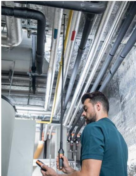
Per facilitare le misure nel condotto di ventilazione, tutte le sonde di portata testo 440 sono munite di una prolunga telescopica estraibile con scala (allungabile opzionalmente da 1 m a 2 m).
