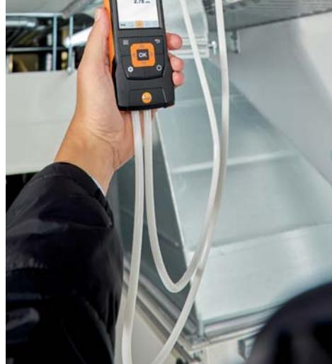
Per misurare la portata volumetrica in presenza di alte velocità dell'aria o correnti molto sporche, consigliamo l'uso dello strumento testo 440 dP con un tubo Pitot.
