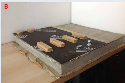
B) Provini per prove di shear su parquet e provini per prove di strappo ("test dolly")
