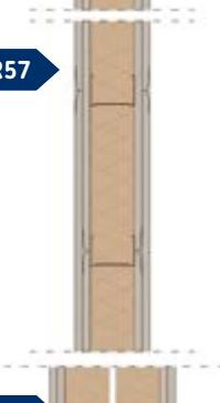
Parete con struttura in acciaio zincato da 75 mm. Rivestimento con due lastre in gesso rivestito standard sp. 12,5 mm per lato. Isolamento in intercapedine con URSA TERRA PLUS 68 sp. 80 mm.
