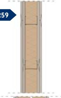
Parete con struttura in acciaio zincato da 75 mm. Rivestimento con strato di lastre in gesso rivestito standard e con strato di lastre in gesso fibro-rinforzato, sp. complessivo 25 mm. Isolamento in intercapedine con URSA TERRA PLUS 70 sp. 80 mm.
