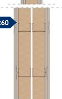
Parete con doppia struttura in acciaio zincato da 50 mm. Rivestimento esterno con due lastre in gesso rivestito standard sp. 12,5 mm per lato e una lastra in gesso rivestito standard sp. 12,5 mm interposta internamente. Isolamento in entrambe le intercapedini con URSA TERRA 76 sp. 45 mm.
