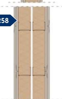
Parete con doppia struttura in acciaio zincato da 50 mm. Rivestimento esterno con due lastre in gesso rivestito standard sp. 12,5 mm per lato. Isolamento in entrambe le intercapedini con URSA TERRA 76 sp. 45 mm.
