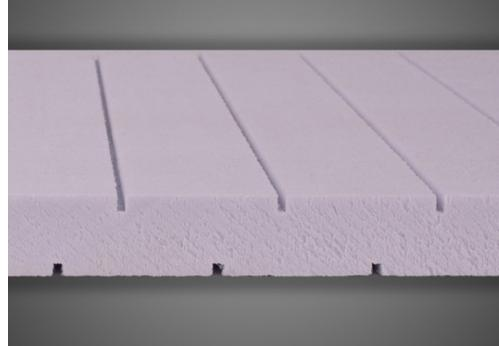
**X-FOAM® TRC** è una lastra per l'isolamento termico costituita da polistirene estruso monostrato di colore indaco, senza pelle di estrusione, con superficie scanalata in senso longitudinale e con i 4 bordi dritti. Le lastre dichiarano valori di resistenza alla compressione da 200 kPa a 300 kPa a seconda dello spessore. Hanno una larghezza pari a 600 mm, lunghezza 3000 mm e spessori disponibili da 20 a 100 mm.
