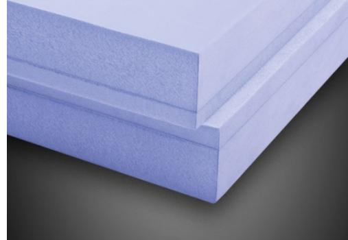
**X-FOAM® HBT 500** è una lastra per l'isolamento termico costituita da polistirene estruso di colore indaco, con pelle di estrusione e con i 4 bordi battentati. Le lastre dichiarano valori di resistenza alla compressione  $\geq 500$  kPa, ed hanno una larghezza pari a 600 mm, lunghezza 1250 mm e spessori disponibili da 50 a 300 mm. X-FOAM® HBT 500 è classificato al fuoco EUROCLASSE E secondo la normativa europea EN 13501-1.
