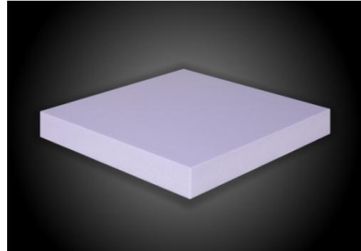
**X-FOAM® HBD** è una lastra per l'isolamento termico costituita da polistirene estruso monostrato di colore indaco, con pelle di estrusione e con i 4 bordi dritti. Le lastre dichiarano valori di resistenza alla compressione  $\geq 300$  kPa, ed hanno una larghezza pari a 600 mm, lunghezza 1250 mm e spessori disponibili da 30 a 100 mm.
