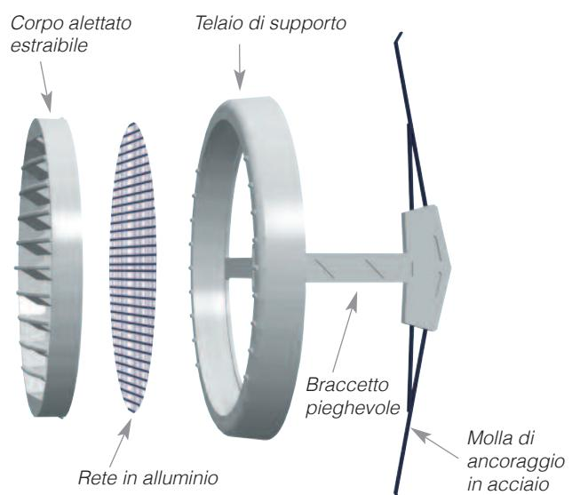
Esempi di smontaggio per manutenzione
