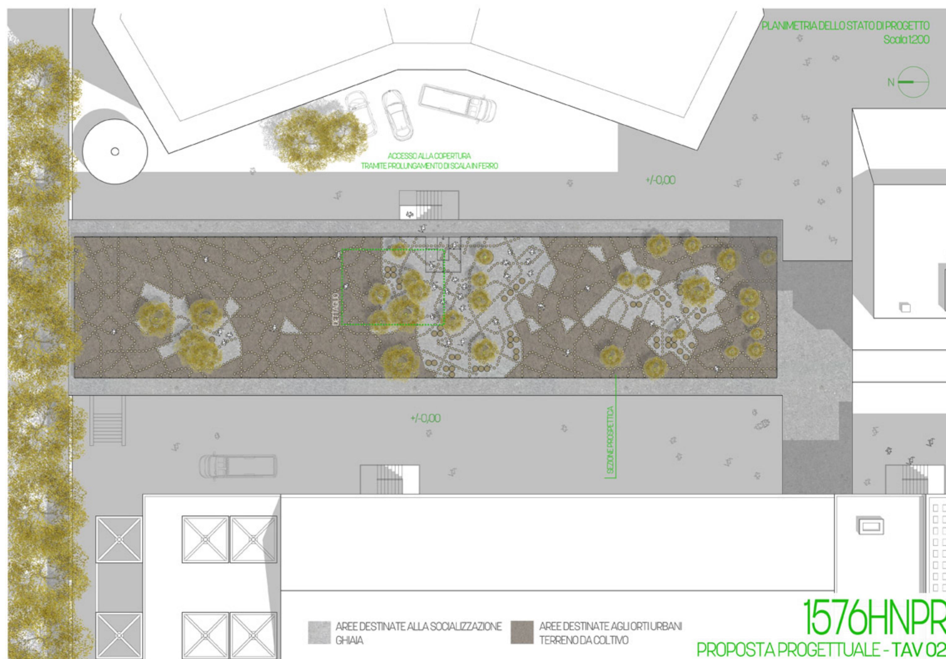
1-BORDURA IN GHIAIA 2-SUBSTRATO TERROSO PER IMPIANTO ORTICOLO 3-GHIAIA PER FORMAZIONE "PIAZZA" 4-SUBSTRATO TERROSO PER ALBERI DA FRUTTO 5-PARAPETTO PER RAMPICANTI 6-CAMMINAMENTI
