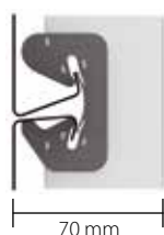
Profondità di sistema con guida modulare a incastro SE
