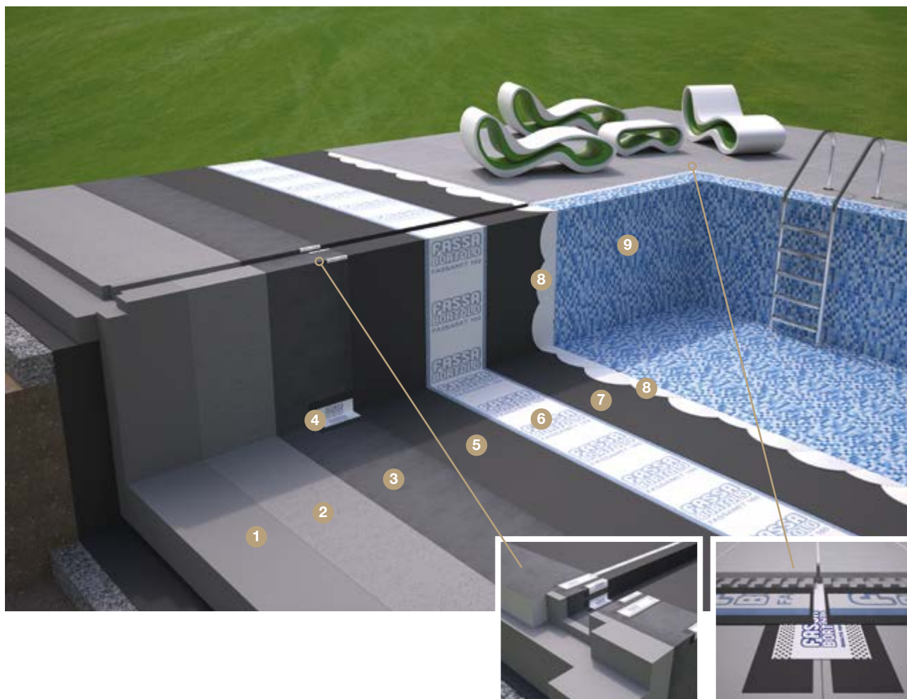
Dettaglio impermeabilizzazione canaletta perimetrale
