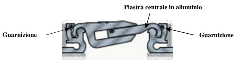
Il principio di assemblaggio di questo coprigiunto consente importanti movimenti verticali ed orizzontali. Le guarnizioni assicurano la tenuta nel tempo alle impurità, acque di lavaggio ed eliminano l'attrito tra l'alluminio. (rumore, usura ...)
