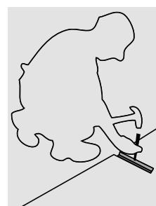
**Inserimento del connettore di coda nell'incavo.**
