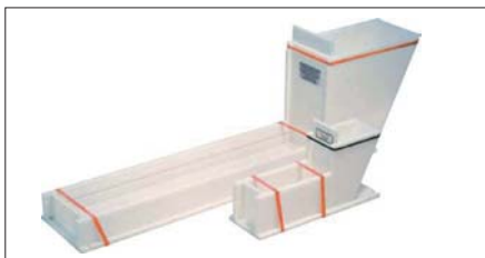
▲ Sottoplastra in plexiglass per la valutazione della quantità e della dimensione delle bolle d'aria in interfaccia
