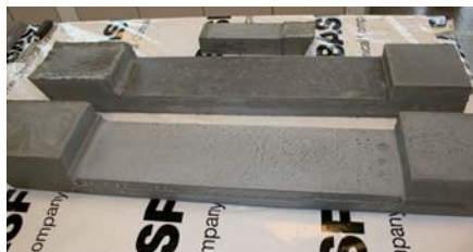
▲ Sottoplastra in plexiglass per la valutazione della quantità e della dimensione delle bolle d'aria in interfaccia
