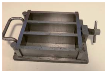
▲ Casseri metallici per le prove di resistenza a compressione ed a trazione per flessione della malte per ancoraggio (UNI EN 12190)
