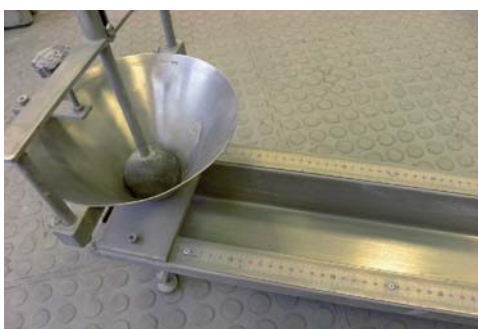
▲ Foto prova di consistenza - misurazione dello scorrimento (UNI 8997)
