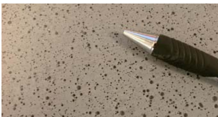
▲ Particolare di una superficie di malta dopo prova del sottoplastra non accettabile: presenza di eccessivo numero di bolle in interfaccia anche di ampie dimensioni
