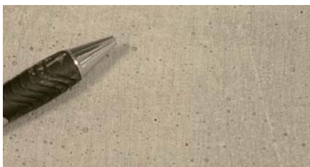
▲ Particolare di una superficie di malta dopo prova del sottoplastra non accettabile: presenza di eccessivo numero di bolle in interfaccia anche di ampie dimensioni
