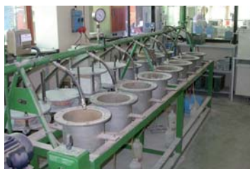
▲ Casseri metallici per le prove di resistenza a compressione ed a trazione per flessione della malte per ancoraggio (UNI EN 12190)
