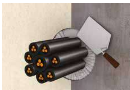
4. Stendere la superficie del sigillante prima della formazione della pellicola con un pennello o una spatola inumiditi con acqua
