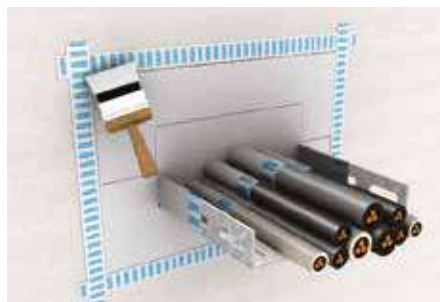
9. Applicare lo spessore corretto di PROMASTOP®-I sulla lana minerale (nel caso in cui i pannelli non siano già pre-trattati) e riempire gli spazi rimanenti. I cavi dovranno essere pitturati. Ripetere l'operazione sul lato opposto se necessario.
