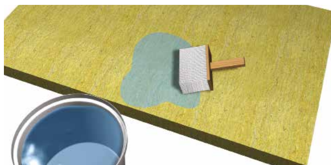
1. Inumidire la lana minerale
