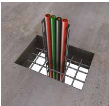
2. Per i solai: installare barre di rinforzo di 300 mm o tasselli metallici sporgenti. Per varchi di grandi dimensioni si suggerisce di includere una rete in acciaio a metà spessore.
