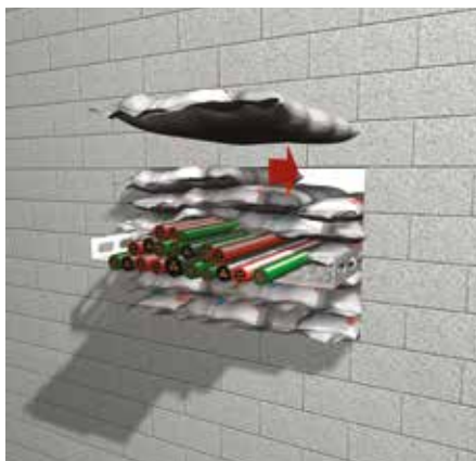
5. Chiudere l'apertura con cuscini antincendio, posandoli come si posano i mattoni, per es. giunti verticali sfalsati. I cuscini devono essere strettamente compattati nell'apertura. È importante che non siano lasciati spazi all'interno dell'apertura o intorno agli attraversamenti
