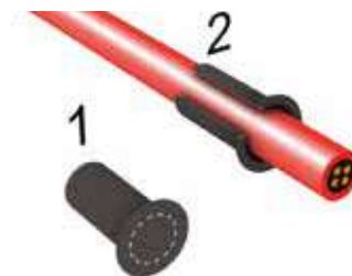
3. 1. Tagliare PROMASTOP®-IM CJ21 su un lato 2. Applicare il cable jacket. Non necessita di sigillatura o sovraverniciatura aggiuntiva
