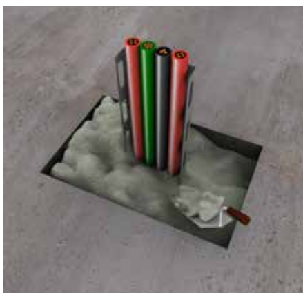
5. Chiudere l'apertura rimanente con PROMASTOP®-M
