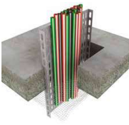
2. Solo per le applicazioni su supporti orizzontali: fissare una struttura di sostegno (per es. una rete in acciaio) all'intradosso del solaio
