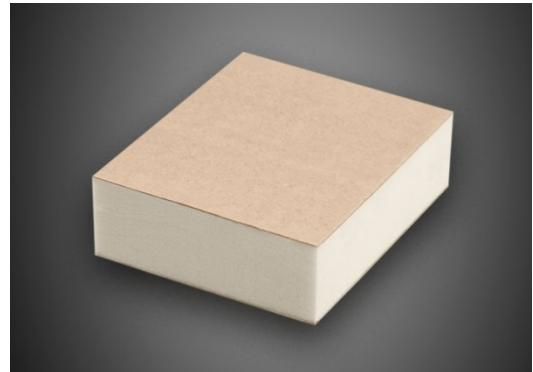
**POLISO® PLUS** è un pannello per l'isolamento termico costituito da una schiuma polyiso (poliuretano espanso) rigida a celle chiuse, di colore giallo, espansa fra due supporti di carta metallizzata multistrato. I pannelli dichiarano valori di  $\lambda_D$  pari a 0,022 W/mK secondo la norma europea EN 13165, valori di resistenza alla compressione  $\geq 150$  kPa ed hanno dimensioni standard pari a 600 x 1200 mm o 1200 x 3000 mm. I pannelli sono disponibili negli spessori da 20 a 140 mm.
