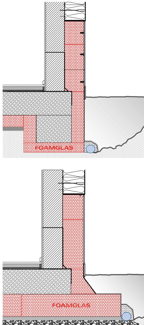
I sistemi visualizzati si riferiscono a edifici passivi. Lo spessore dell'isolante è in relazione alla classe energetica prescelta e alla località di costruzione.
