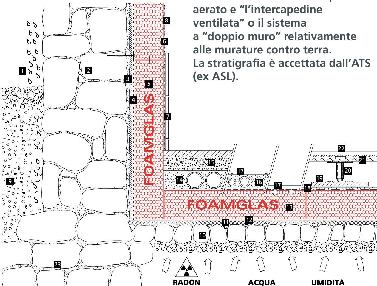
**Il sistema sostituisce il vespaio aerato e "l'intercapedine ventilata" o il sistema a "doppio muro" relativamente alle murature contro terra.
