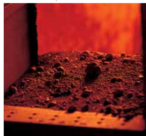
Cottura a 1.200 gradi ed espansione.
