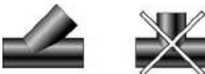
Figura 9. Utilizzare solo braghe a 45°, non a 90°.
