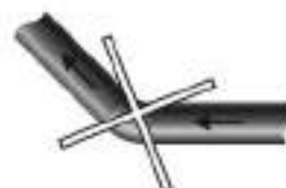
Figura 6. Non inserire curve rivolte verso l'alto.
