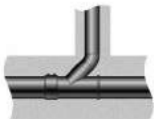
Figura 83. Fissaggio nel calcestruzzo con un manicotto elettrico.
