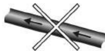
Figura 5. Nessuna pendenza negativa.
