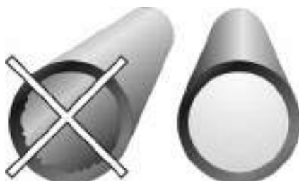
Figura 7. Estremità dei tubi tagliate in modo non corretto e corretto
