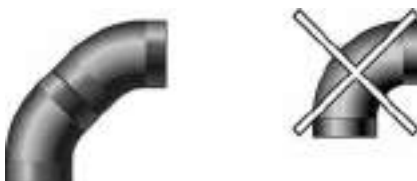
Figura 8. Utilizzare solo curve a 45°, non a 90°.
