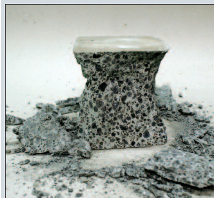
Cubetto sottoposto a rottura.
