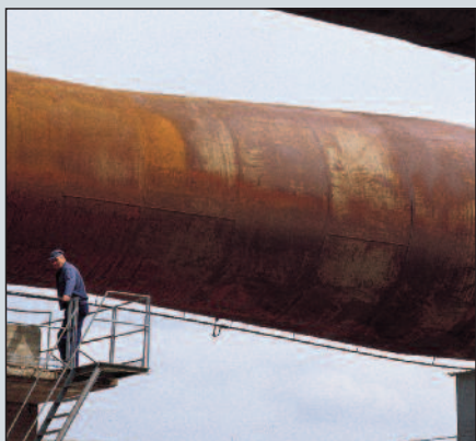
Il forno rotante per la cottura dell'argilla.
