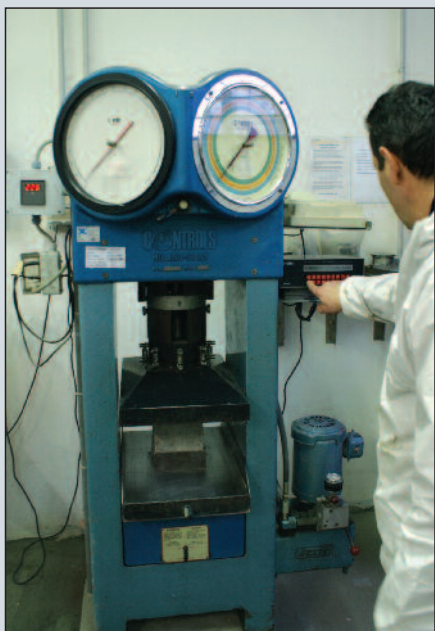
Pressa per determinazione resistenza a compressione.
