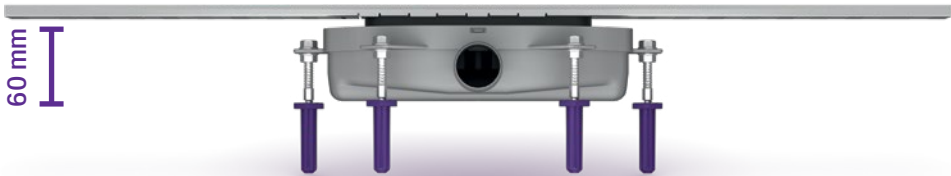
Profondità di installazione di 60 mm con Megastop / chiusura antiodore di 24 mm
