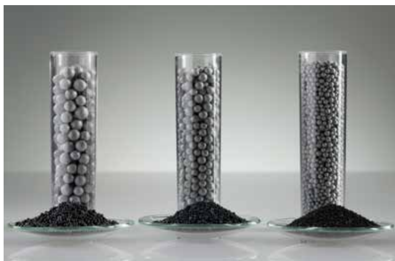
Perle di Neopor®, prima e dopo il processo di espansione.
