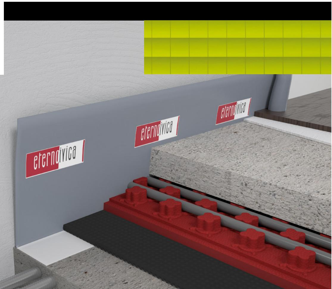
Fascia perimetrale in polietilene elasticizzato chimico compatto a celle chiuse, composta da una parte verticale di colore grigio sp. 6 mm e una parte orizzontale di colore bianco sp. 2 mm dotata di pre-tagli ad altezza 18, 16 e 14 cm, entrambe adesivizzate su un lato.
