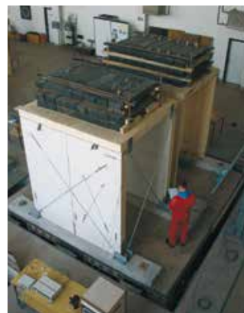
Test allo Shake Table. Le graffe fuoriescono dopo esser state sottoposte a Petrovac.
