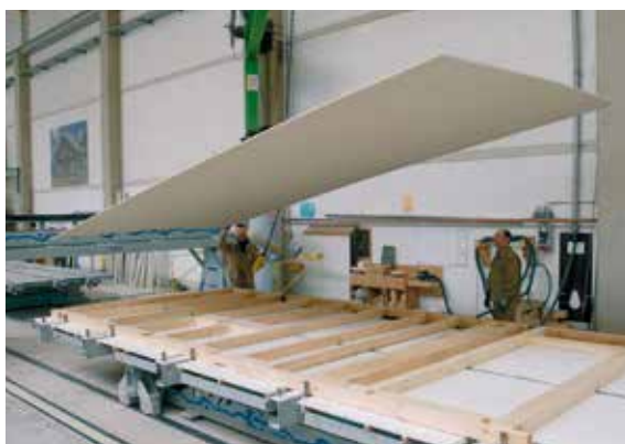
Edificio multipiano realizzato in legno con pannelli intelaiati rivestiti con lastre di gessofibra FERMACELL.
