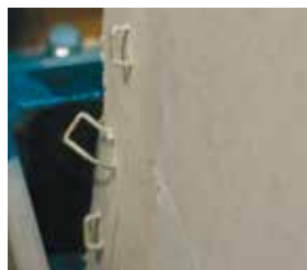
Test allo Shake Table. Le graffe fuoriescono dopo esser state sottoposte a Petrovac.
