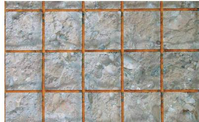
La malta fibrorinforzata tixotropica SPECIAL WALL B 550 M può essere applicata con estrema semplicità e rapidità sia a mano che con macchine intonacatrici tipo FASSA I 41 e simili; la rete elettrosaldata dovrà essere coperta da almeno 2 cm di prodotto e lo spessore totale della malta SPECIAL WALL B 550 M dovrà essere di almeno 4 cm.
