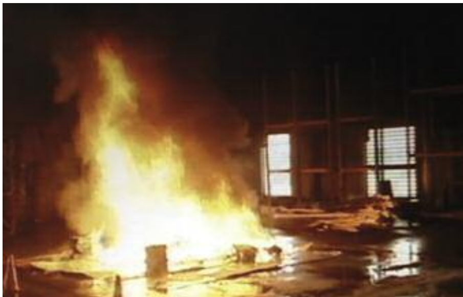
Figura 4 - Prove d'incendio con SEFC attivo
