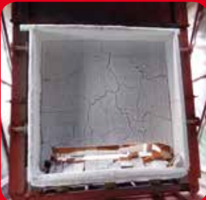
Effetto dell'intumescenza su vernice Amotherm Brick sottoposta a fonte di calore durante test sperimentali.
