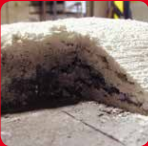
Muro trattato al termine del collaudo in forno sperimentale.
