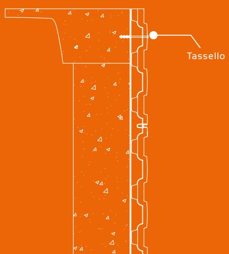
In prossimità del cordolo del solaio, fissare il pannello più alto con un tassello (preferibilmente chimico e non meccanico).
