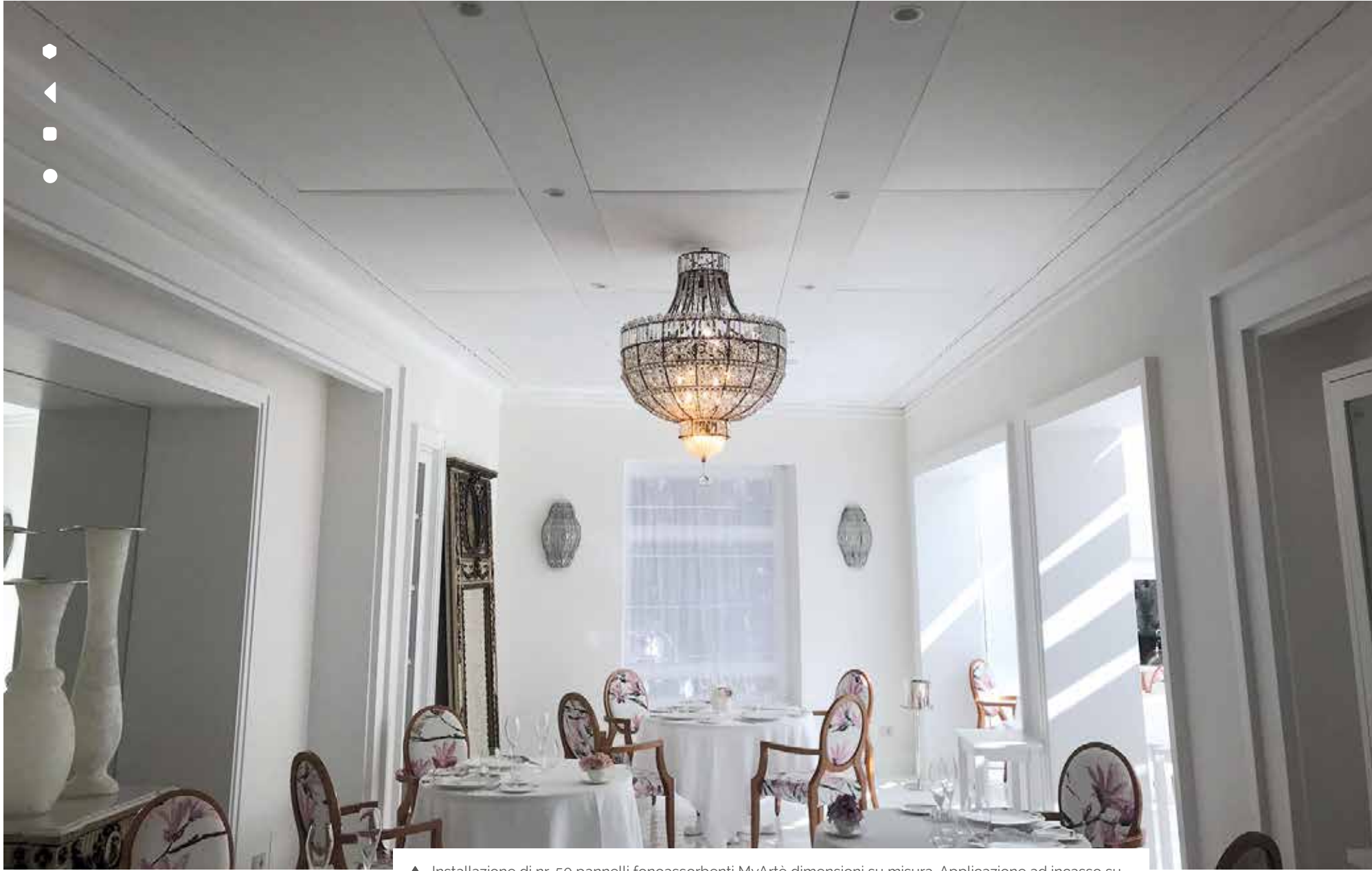
▲ Installazione di nr. 50 pannelli fonoassorbenti MyArtè dimensioni su misura. Applicazione ad incasso su controsoffitto in cartongesso. Italia - Ristorazione. Application of 50 sound absorbing panels. Customized dimensions. Installed on the existing false-ceiling. Italy - Restaurant.
