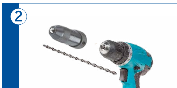
2 Inserimento sul trapano dell'adattatore per la barra elicoidale.
