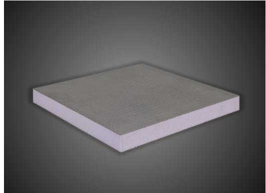
**ALGOCEM®** è un pannello sandwich prefabbricato costituito da un'anima in polistirene estruso X-FOAM® e finito, su uno o entrambi i lati, da un rivestimento in malta cementizia rinforzata da una rete in fibra di vetro. I pannelli hanno dimensioni standard 600 x 1250 o 600 x 2500 mm e spessori variabili da 4 a 120 mm. I pannelli sono classificati al fuoco EUROCLASSE E secondo la normativa europea EN 13501-1.
