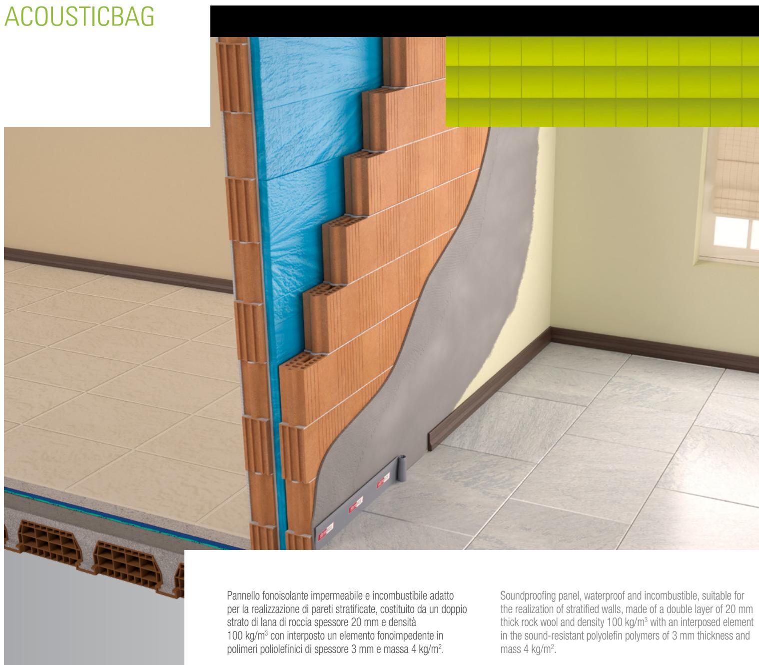
Pannello fonoisolante impermeabile e incombustibile adatto per la realizzazione di pareti stratificate, costituito da un doppio strato di lana di roccia spessore 20 mm e densità 100 kg/m<sup>3</sup> con interposto un elemento fonoimpedente in polimeri poliolefinici di spessore 3 mm e massa 4 kg/m<sup>2</sup>.
