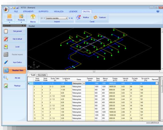
**Il programma è completamente automatico, ma interattivo:** è possibile modificare i parametri di progetto, ripetere il calcolo e verificare gli effetti in termini di dimensioni dei canali, caratteristiche del ventilatore e costi dell'impianto.
