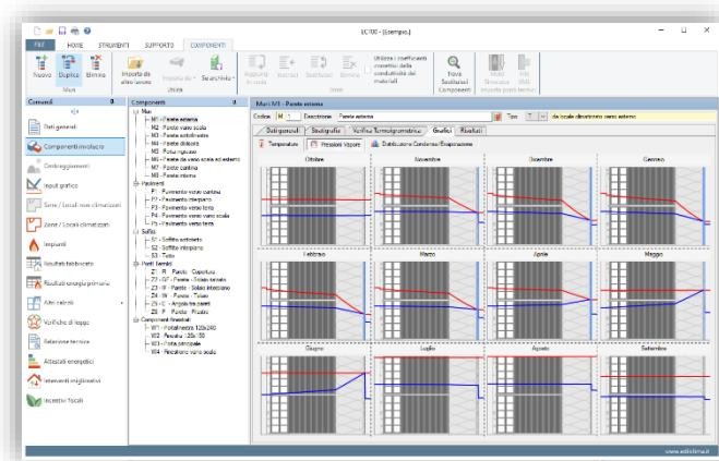
I risultati della verifica termoigrometrica vengono presentati sia in **forma grafica** che **tabellare**: vengono rappresentati la sezione della struttura ed i grafici, con l'andamento mensile delle curve di temperatura, pressione di vapore e di saturazione degli strati costituenti la struttura (**diagrammi di GLASER**).
