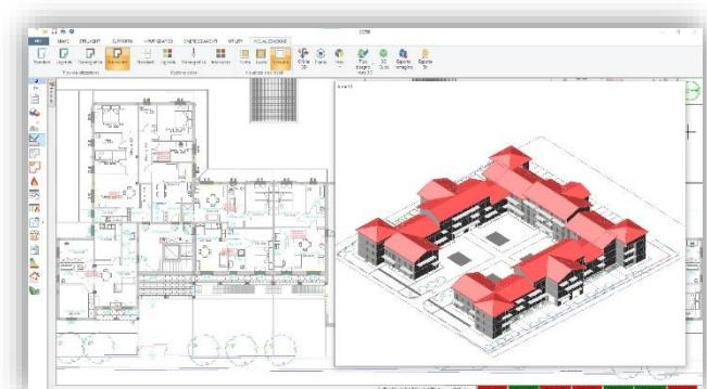
È possibile visualizzare il **rendering delle ombre** dell'edificio, con indicazione in tempo reale e per ciascuna ora dell'anno, del percorso del Sole e delle ombre generate sui prospetti dell'edificio. Tale funzionalità è utile, ad esempio, per la progettazione degli aggetti e per una valutazione qualitativa dell'impatto di edifici vicini o degli ombreggiamenti dovuti alla forma dell'edificio.
