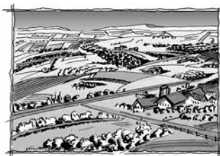
Dis. 3: Categoria territoriale II – Aree con vegetazione bassa e singoli ostacoli (alberi, edifici) distanziati tra loro di almeno 20 volte la loro altezza.
