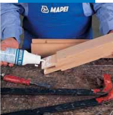
Incollaggio di serramenti in legno per esterno
