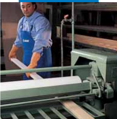
Spalmatura a rullo di Adesivil D3 per accoppiamento di elementi in legno
