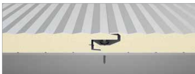
Fissaggio nascosto Concealed fixing
