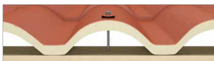
Fissaggio su legno Fixing on wood
