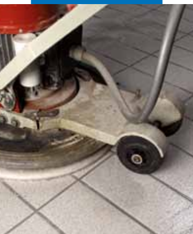
Pulizia con acqua utilizzando una macchina a mezzo-disco rotante equipaggiata con dischi in feltro abrasivo tipo "Scotch-Brite®"
