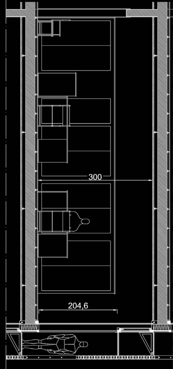
SEZIONE UFFICIO CON APPLICAZIONE DEL SISTEMA SCHERMANTE
