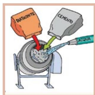
In caso di applicazione con macchina intonacatrice Diathonite può essere miscelata in betoniera a secco e applicata con pompa tradizionale a polmone o con pompa da premiscelato (in entrambi i casi è preferibile l'utilizzo di un polmone usato per garantire una buona resa e messa in opera del prodotto). L'ugello di uscita deve avere un diametro minimo di 16 mm. Assicurarsi che i giunti di collegamento dei tubi non abbiano strozzature.
