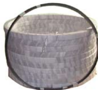
2.3 Le lamine MBrace Lamine hanno spessore 1.4 mm, larghezza 50 o 100 mm e sono avvolte in rotoli di 50 m di lunghezza. Possono essere tagliate a misura con seghetto
