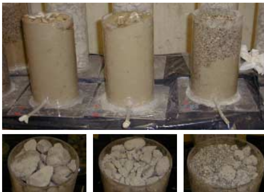
Fig. 8: Prove di iniettabilità in cilindri riempiti con diversi tipi di supporto (Valluzzi, 2000).
