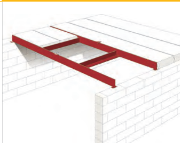
2 Cavedio nel solaio YTONG: larghezza di 2 lastre
