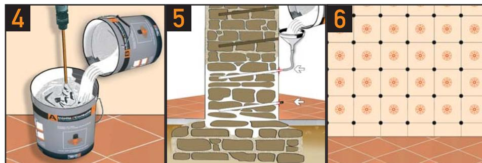
Utilizzando un mescolatore unire il componente B al componente A sino ad ottenere un impasto fluido ed omogeneo. I componenti miscelati devono essere impiegati entro 2/3 ore.
